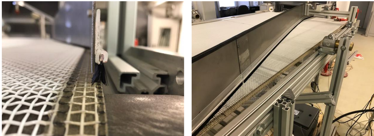
Abb. 60: Aufnahmen des Führungsblechs
